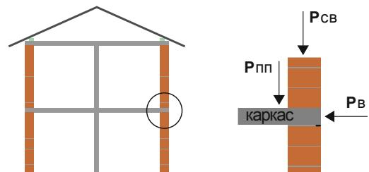
**ненесущие** - воспринимающие нагрузку только от собственного веса и ветра в пределах одного этажа при высоте этажа не более 6 м, при большей высоте этажа эти стены относятся к самонесущим;
