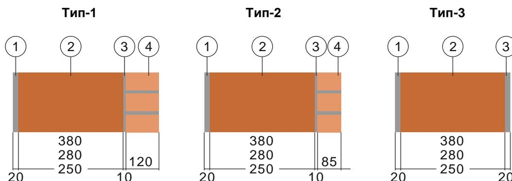
**Стена Тип-1 (Тип-1-380, Тип-1-280, Тип-1-250)** конструкция из помещения наружу:
